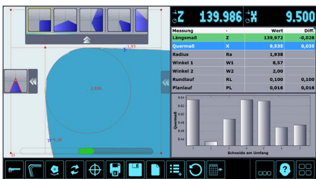
Automatické rozeznání měřícího rozsahu a více než 90 rozdílných tvarů břitů. Přehledné grafické a numerické znázornění výsledků měření během okamžiku.
